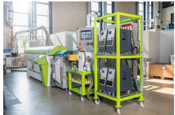
Abbildung 1: Kautschukextrusions- und Vulkanisationslinie am IKV | Foto: IKV/Fröls
