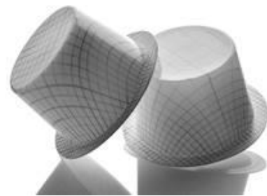
Abbildung 1: Tiefgezogene Becher mit Linienmuster zur Analyse der lokalen Dehnungsverhältnisse [IKV]
