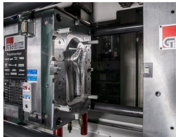
Abbildung 1: Werkzeug mit servoelektrisch angetriebener Verschlussnadel
