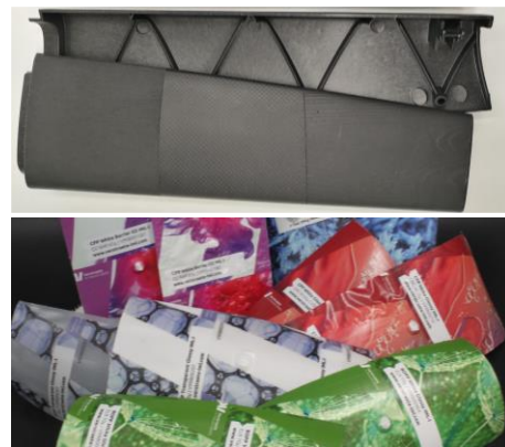
Abbildung 1: Verbesserung der Oberflächenqualität von geschäumten Formteilen (oben) sowie Dünnwandige In-Mould-Label-Verpackungen (unten)
