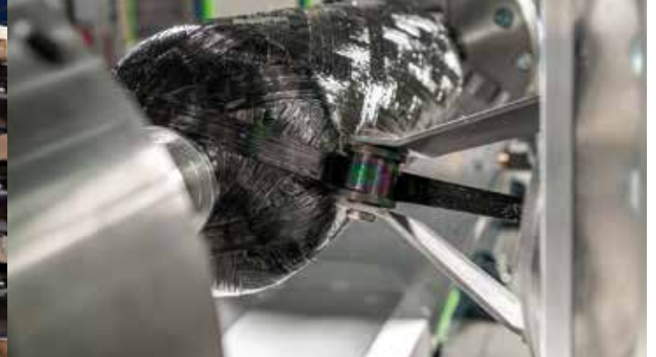
Oben: Stapel mit Druckbehältern und Detailansicht der Wickelanlage mit Legekopf / Above: Stack with pressure vessels and detailed view of the winding unit with laying head | Photos: NPROXX/IKV/Fröls
