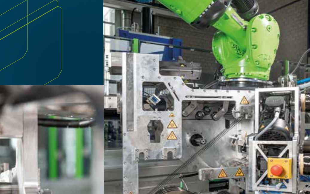
Links: Wickelanlage im FVK-Technikum des IKV / Left: Winding line in IKV's technical centre for FRP | Photos: IKV/Fröls
