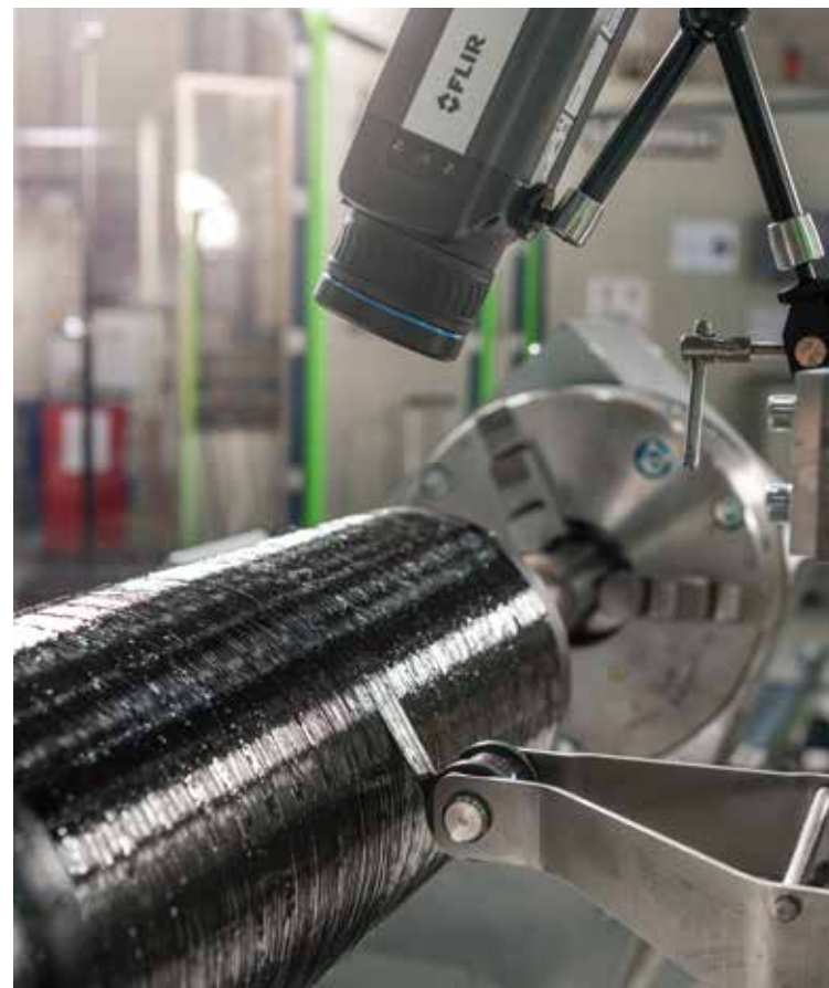
Links: Gesamtansicht der Anlage für das Nass- und Towpreg-Wickeln im FVK-Technikum / Left: General view of the wet and towpreg winding line in the FRP technical centre. | Photo: IKV/Fröls
