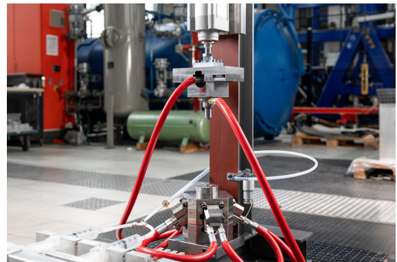
Bild 1: Neuartige RPCSA zur Charakterisierung von prozessrelevanten Materialeigenschaften.
