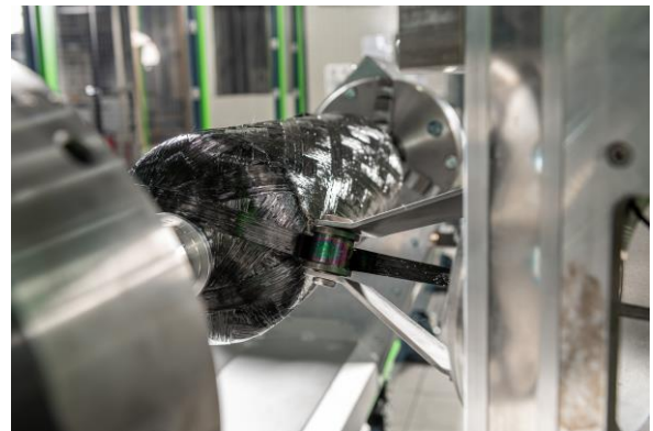
Abbildung 1: Nasswickeln eines Typ-IV Druckbehälters
